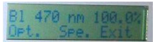
Man erkennt, dass es sich um eine Messung mit der blauen Leuchtdiode handelt. Der Messwert beträgt 100 % Transmission. Der Wert kann gespeichert werden.
