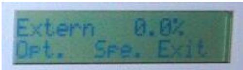
In der oberen Zeile steht hier der Messkanal und der Messwert – in der unteren Zeile die Bedeutung der darunter liegenden Tasten.
