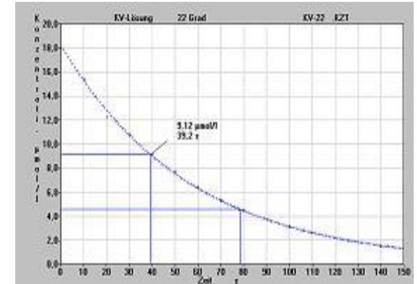
Bildschirmausdruck der Konzentrationskurve bei der Entfärbung von Kristallviolett mit Natronlauge und einfacher Reaktionskinetischer Auswertung.
