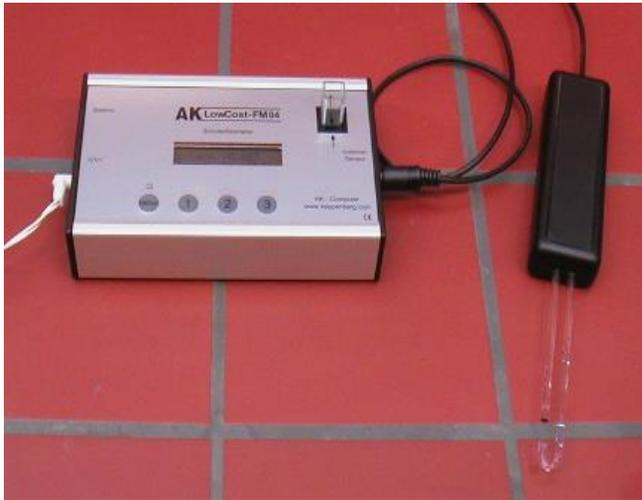
Abbildung des Fotometers mit 10x10 mm Standardkuvette und Tauchvorsatz.
