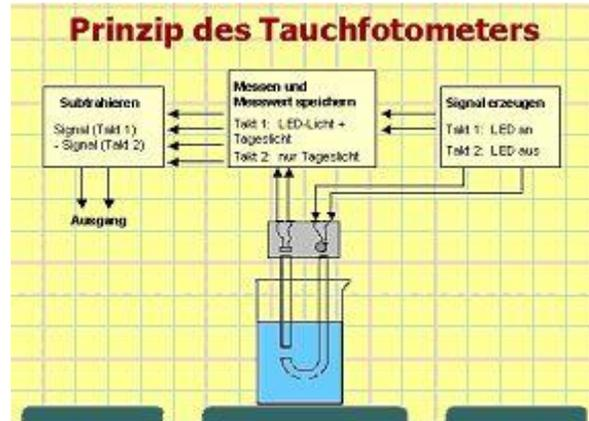
Das eigentliche Messsignal entsteht durch Subtraktion zweier Messsignale einmal mit und einmal ohne Umgebungslicht.
