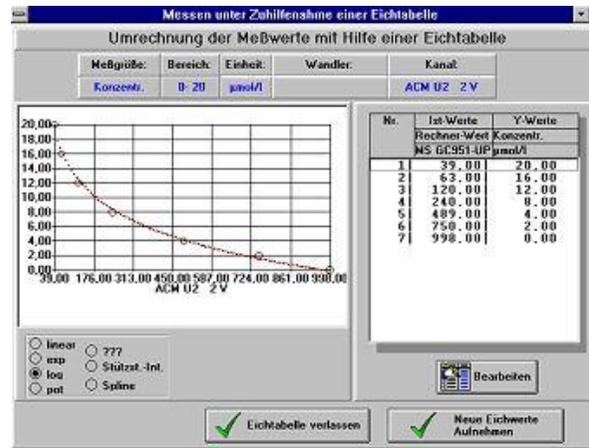
Bildschirmausdruck einiger Kalibrierwerte und der zugehörigen Kurve. Die Funktionswerte können im Fotometer gespeichert werden und dienen zur Umrechnung und direkten Anzeige der Messwerte in Konzentrationseinheiten.
