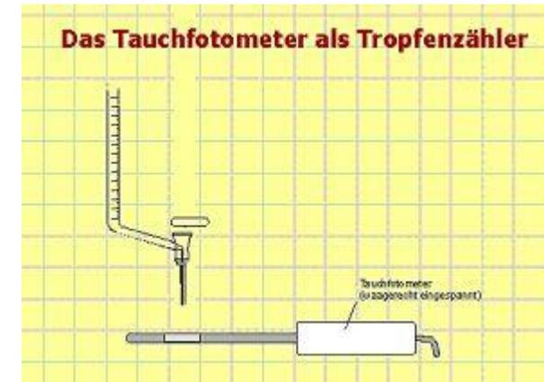
Spannt man den Tauchvorsatz quer ein, so kann das Fotometer die durch die Messstrecke fallenden Tropfen zählen. Das kann man zur Volumenbestimmung bei Titrationen benutzen.
