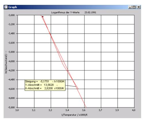
Die Steigung des Graphen muss nun noch mit R (8,314 J/mol·K) multipliziert werden und man erhält die Aktivierungsenergie dieser Reaktion: 95.61 kJ/mol (direkt in kJ, weil der Faktor 1000 schon bei der reziproken Temperatur eingerechnet war).
