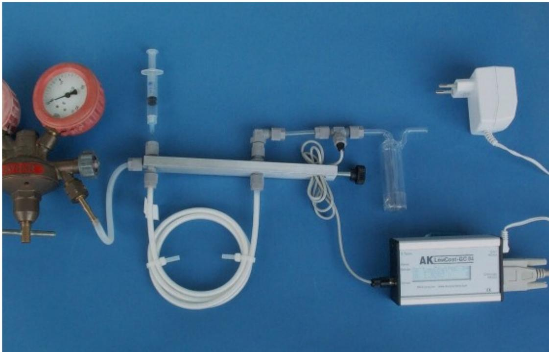
Beispielfoto für den Betrieb des **AK LCGC 04** mit Wasserstoff oder Helium aus der Druckgasflasche (Regelung mit dem Gasventil - Kontrolle mit dem Blasenähler: etwa 1 Blase / s).
