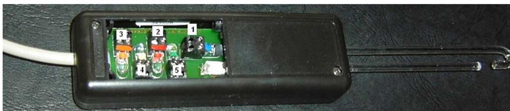
**Achtung:** Wenn man mit dem Tauchvorsatz arbeiten will ("→Tauchvorsatz Extern"), muss sichergestellt sein, dass die richtige LED beschaltet ist (**Die Farbe muss im Glasansatz leuchten; evtl. LED im Handgriff wechseln!**). Auch hier sollte ein "→Nullabgleich" erfolgen.
