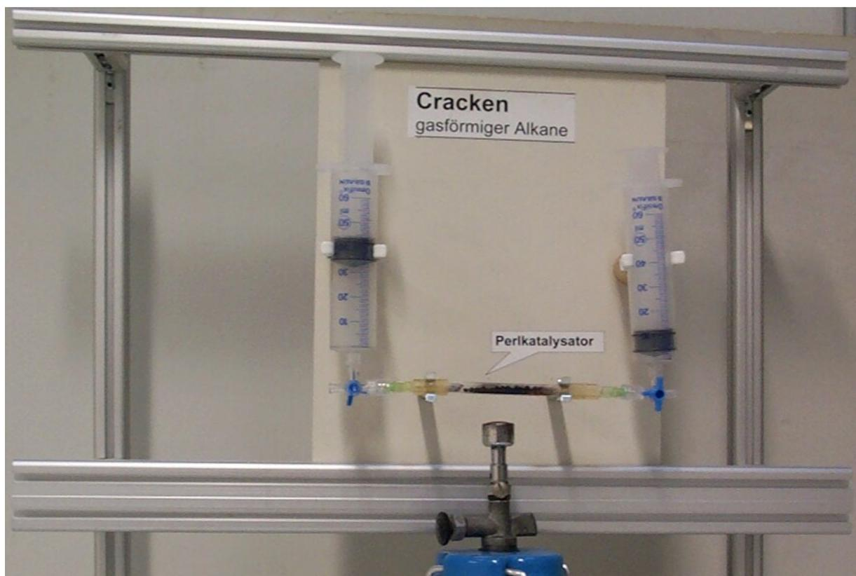
**Tipps** Bezug des Katalysators: 0,5 % Palladium auf Aluminiumoxid-Kugeln (Fa. Hedinger)
