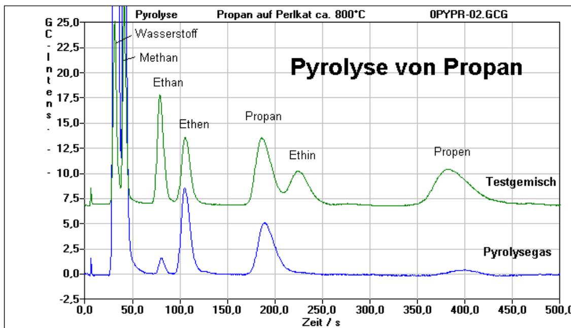
Wie das Chromatogramm zeigt, entstehen eine Reihe (mindestens 6!) von Produkten. Diese können mit Vergleichsgasen identifiziert werden.
